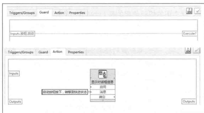
图 12-101 设置转移保护与转移的动作响应
