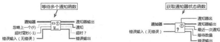
图 10-48 “等待多个通知”函数、“获取通知器状态”函数
