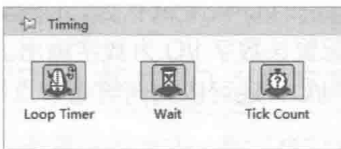
图 17-13 FPGA 定时函数
