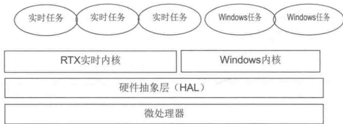
图 15-4 RTX 的软件架构
