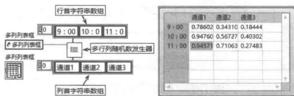
图 7-10 随机数发生器调用方法
