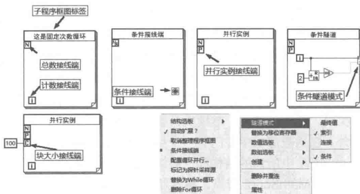
图 3-2 For 循环结构的端口及快捷菜单
