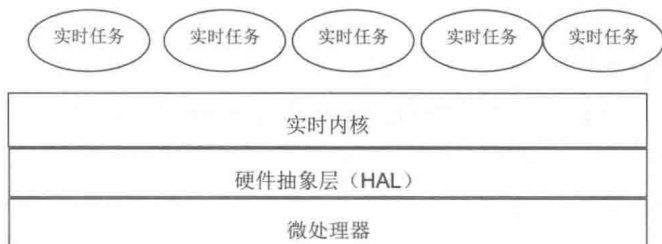
图 15-3 ETS 的软件架构
