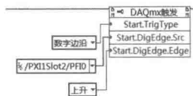
图 16-64 设置触发属性的例子
