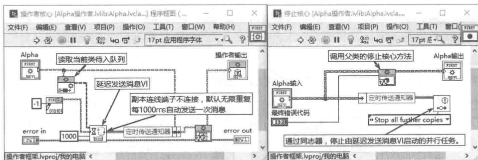
图 12-95 重写 Alpha 操作者的“操作者核心”方法与“停止核心”方法
