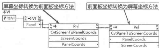
图 6-14 前面板坐标和屏幕坐标的相互转换
