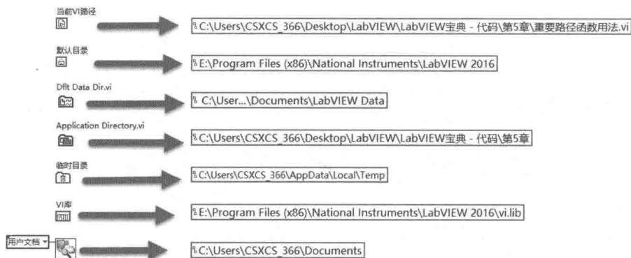
图 5-36 常用路径函数用法
