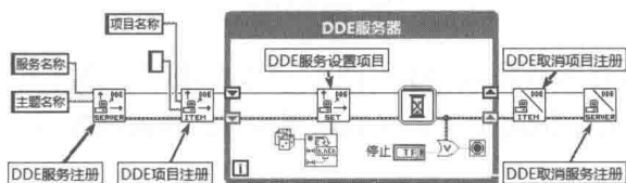
图 8-40 DDE 服务器定时发送数据
