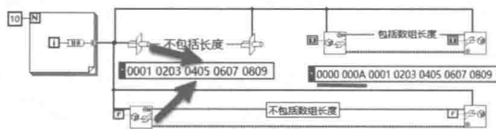
图 4-8 将数组平化至字符串及从字符串还原
