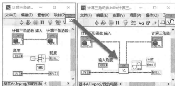
图 12-81 角度转换为弧度私有方法、计算正弦公共方法
