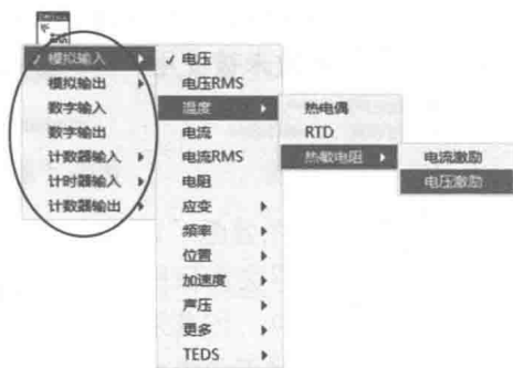
图 16-41 “DAQmx 创建通道”函数可选的实例选项
