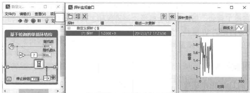
图 12-11 自定义波形图表控件探针
