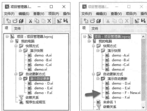
图 10-56 虚拟文件夹的快照方式与自动更新方式
