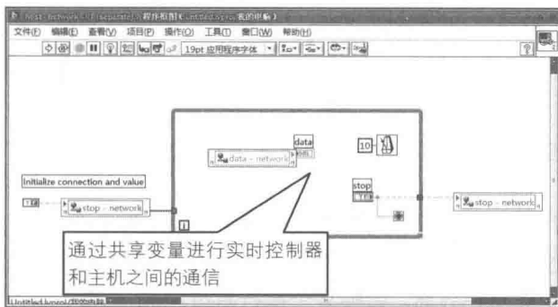
图 15-18 主机系统中的主函数
