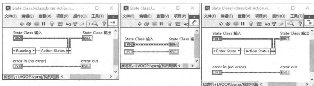
图 12-45 抽象状态类的 Enter Action 方法、Action 方法、Exit Action 方法
