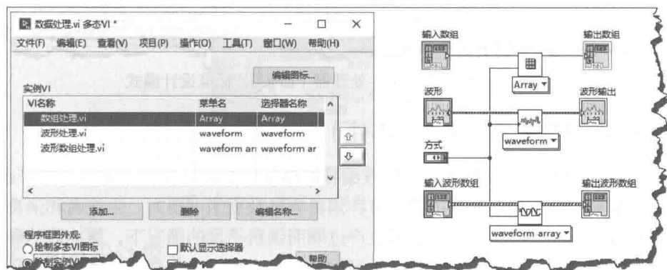
图 12-19 使用多态 VI 重构程序框图
