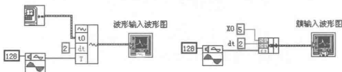
图 7-59 波形图显示波形数据和簇时的区别
