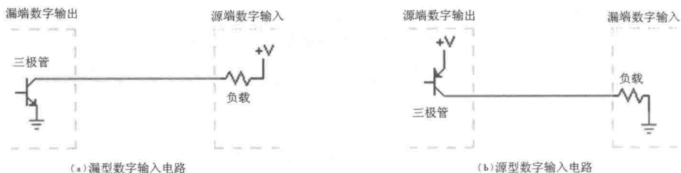
图 16-13 漏端和源端电路图
