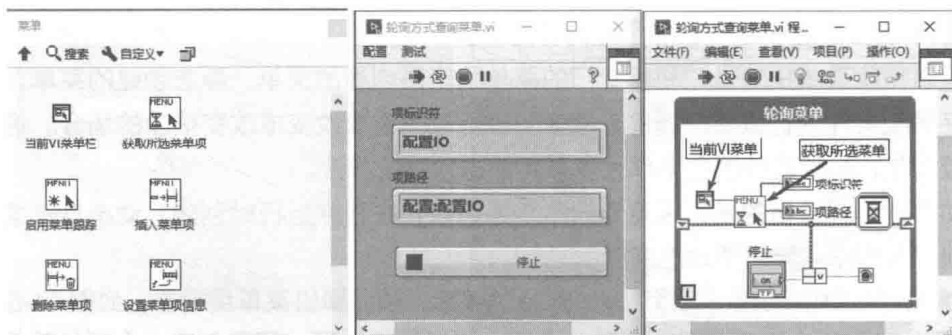
图 11-6 “菜单”函数选板，轮询方式查询菜单
