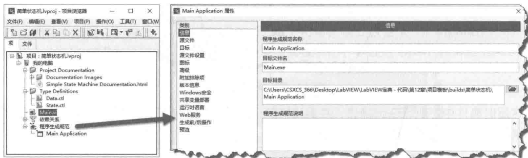
图 12-60 项目模板的基本组成结构
