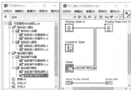
图 11-44 虚拟文件夹的结构、“鼠标离开颜色写入”属性
