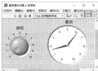
图 1-34 修改后量表控件的显示效果
