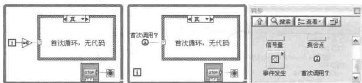
图 3-50 首次空循环实现真正的 While 循环
