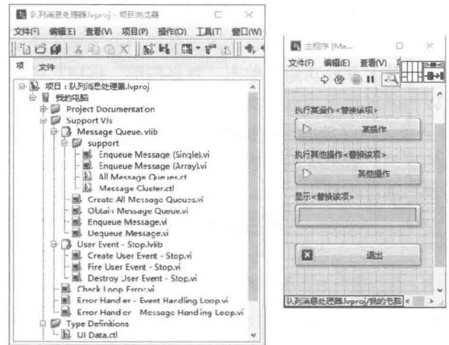
图 12-64 队列消息处理器模板的基本构成
