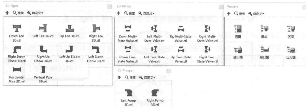
图 13-50 管道、阀门、泵与容器控件
