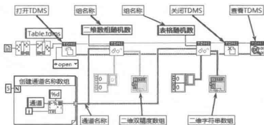
图 5-101 读取二维数值数组和字符串数组
