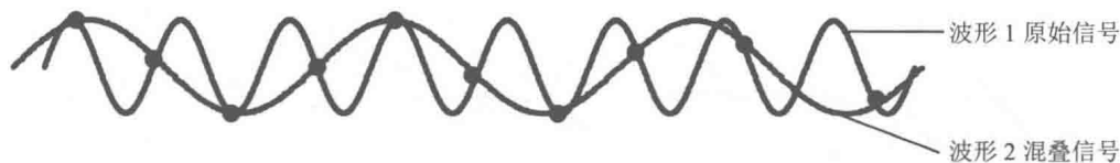
图 16-21 信号混叠示意图
