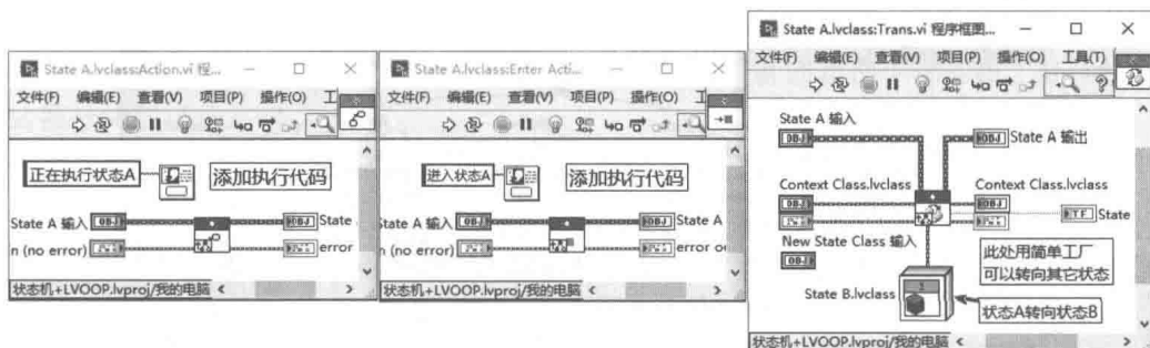
图 12-47 状态 A 类的 Action 方法、Enter Action 方法、Tans 方法
