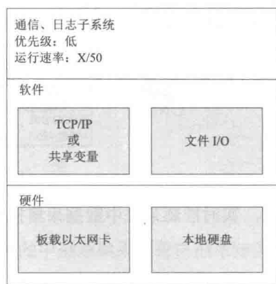
图 15-57 通信及日志子系统的架构
