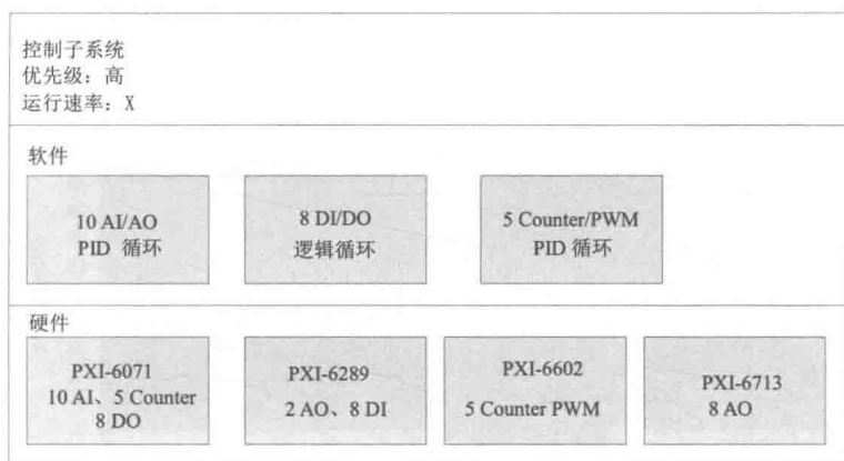
图 15-55 控制子系统架构
